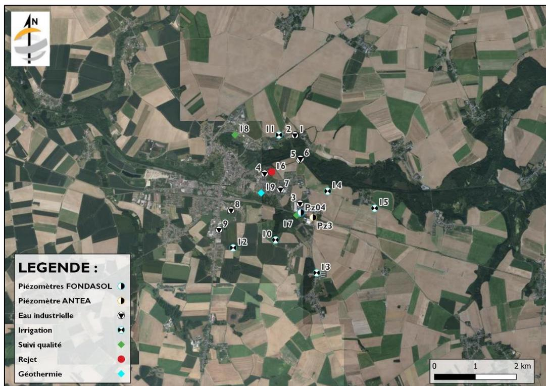
Figure 5 : Usages des eaux souterraines actifs dans un rayon de 2 km autour des ouvrages
